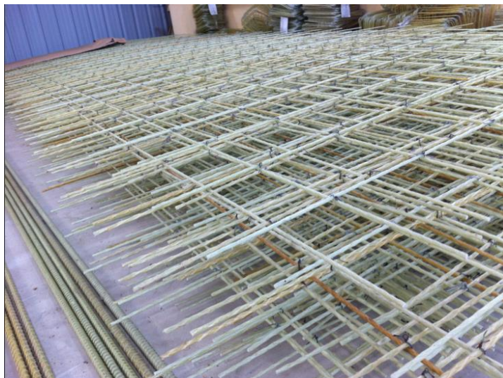
Hình 3.5: Cốt composite polyme thay thế cốt thép
